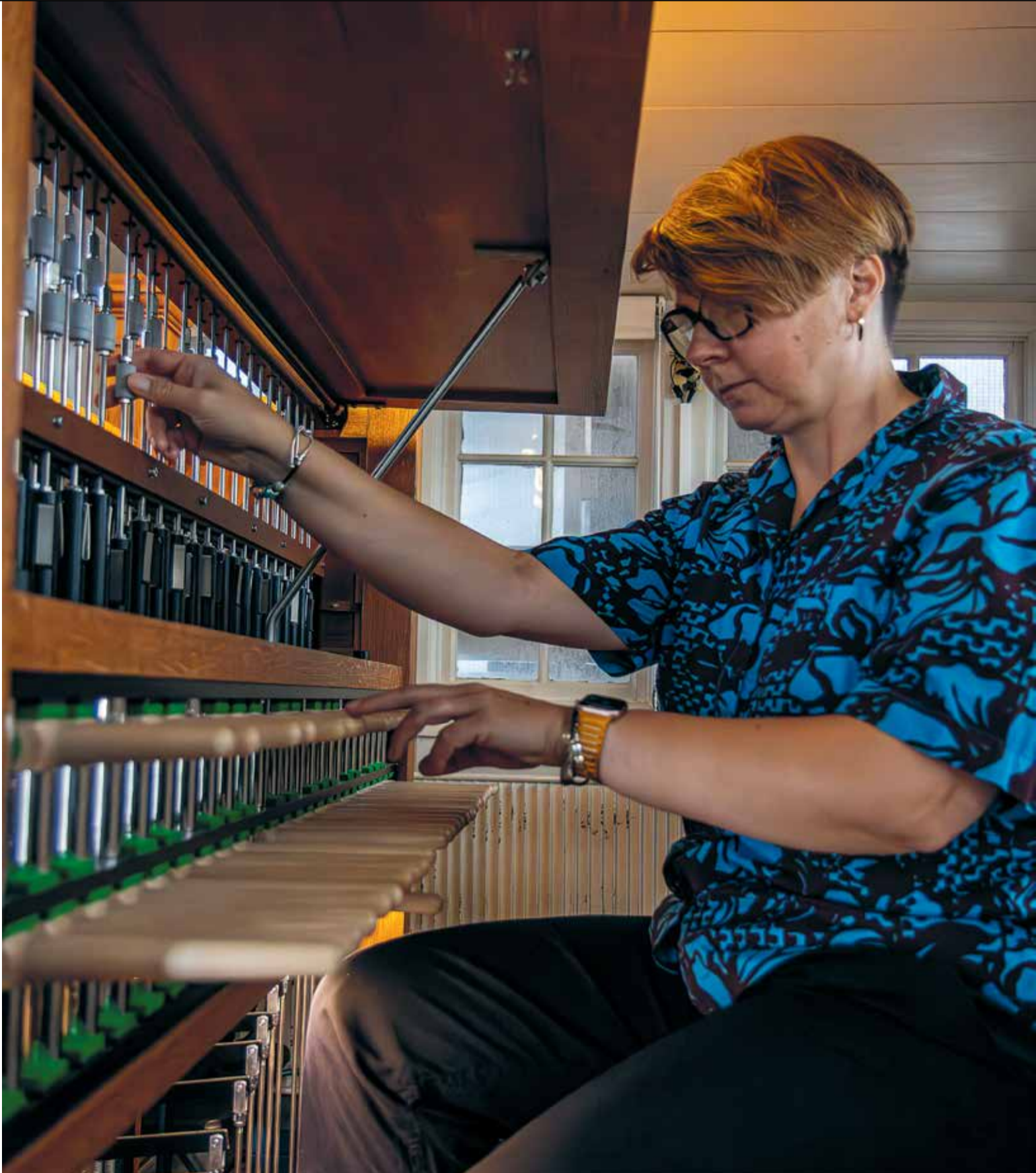
Voordat beiaardier Malgosia Fiebig met spelen begint, stelt ze de draden die naar de klepels lopen bij. Foto: Ton Verweij
